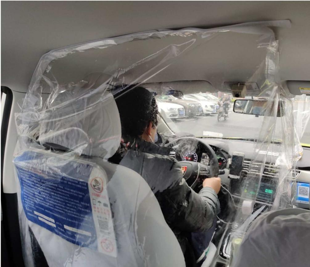
Montage non autorisé si distorsion de la vision et si risque de chute du dispositif sur le conducteur
